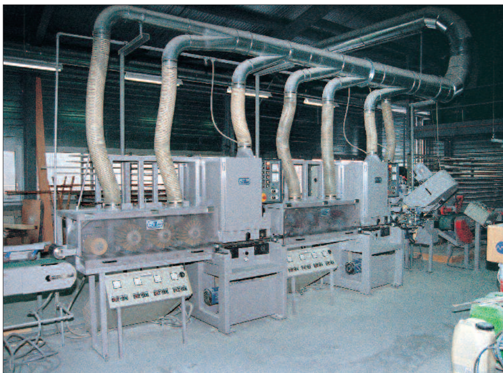
Chaîne industrielle de traitement de la lame: ponçage, brossage.
