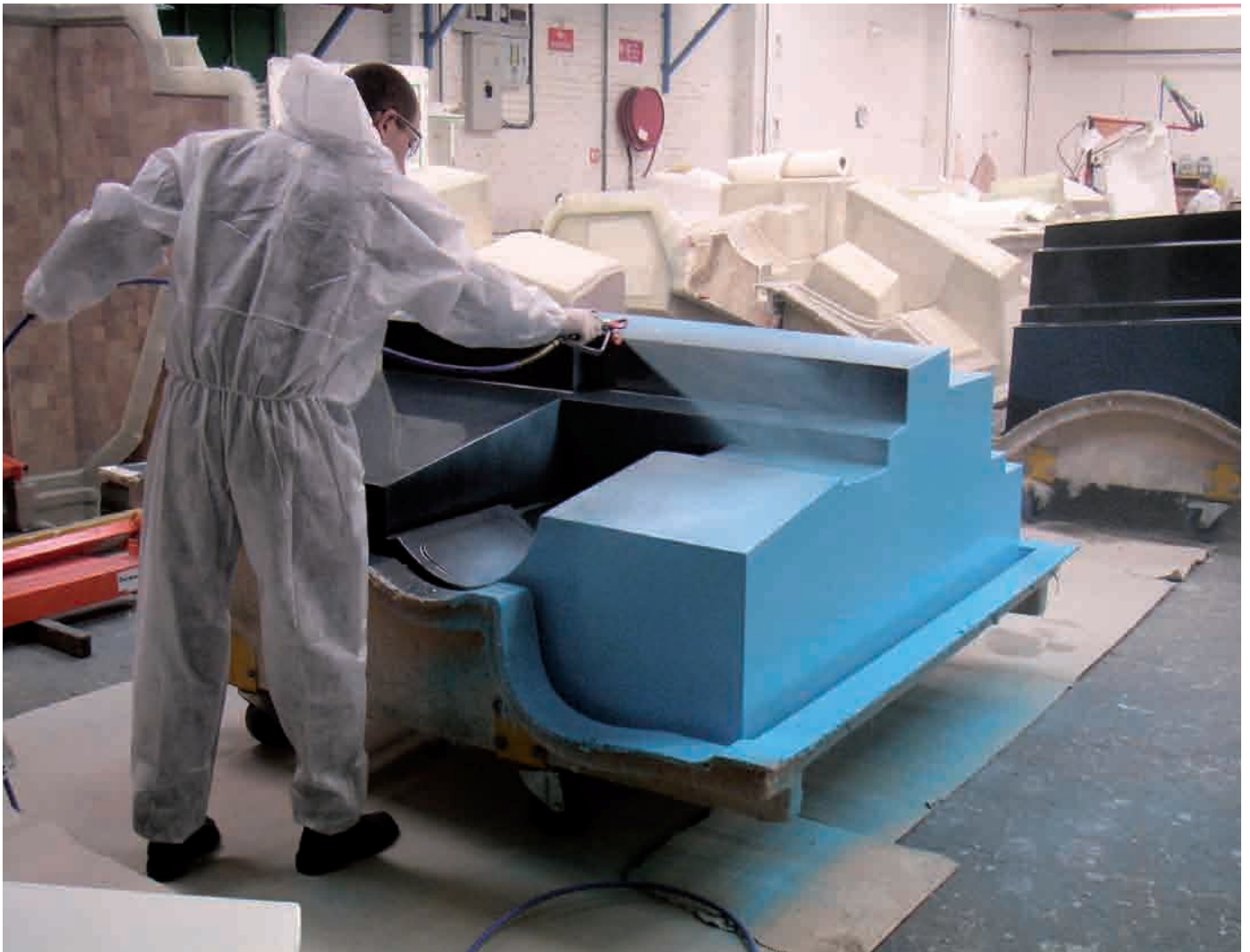
Élément polyester d'un bateau protégé au Deckstrip. Mit Deckstrip geschütztes Polyesterbauteil eines Schiffes.
