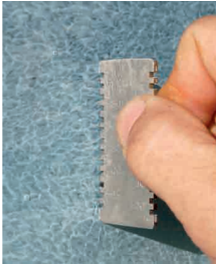
Mesure d'épaisseur du film humide. Messen der Nassfilmdicke.
