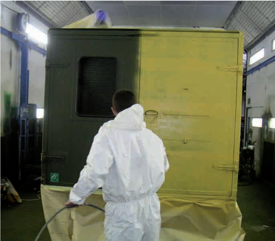
Le Deckstrip appliqué par giclage...
