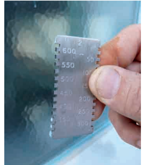
Le peigne d'épaisseur indique le nombre de microns de produit appliqué.
