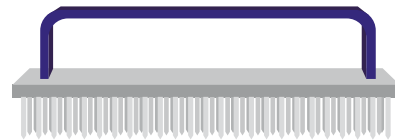
Aucun mortier ne doit rester collé à l'outil de grattage.
